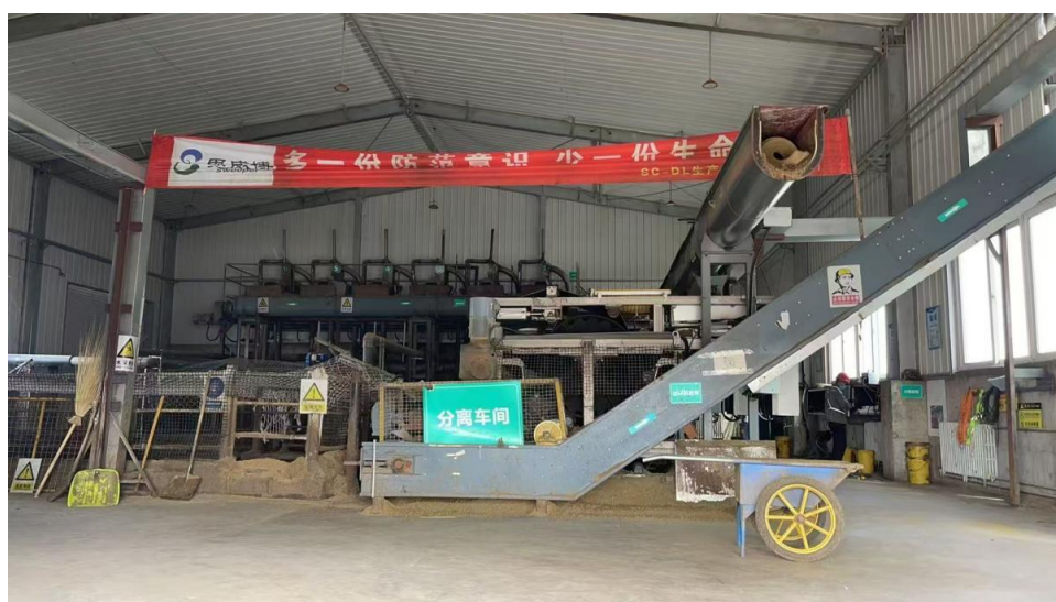
图 2 粪污处理托管运行模式—固液分离车间
