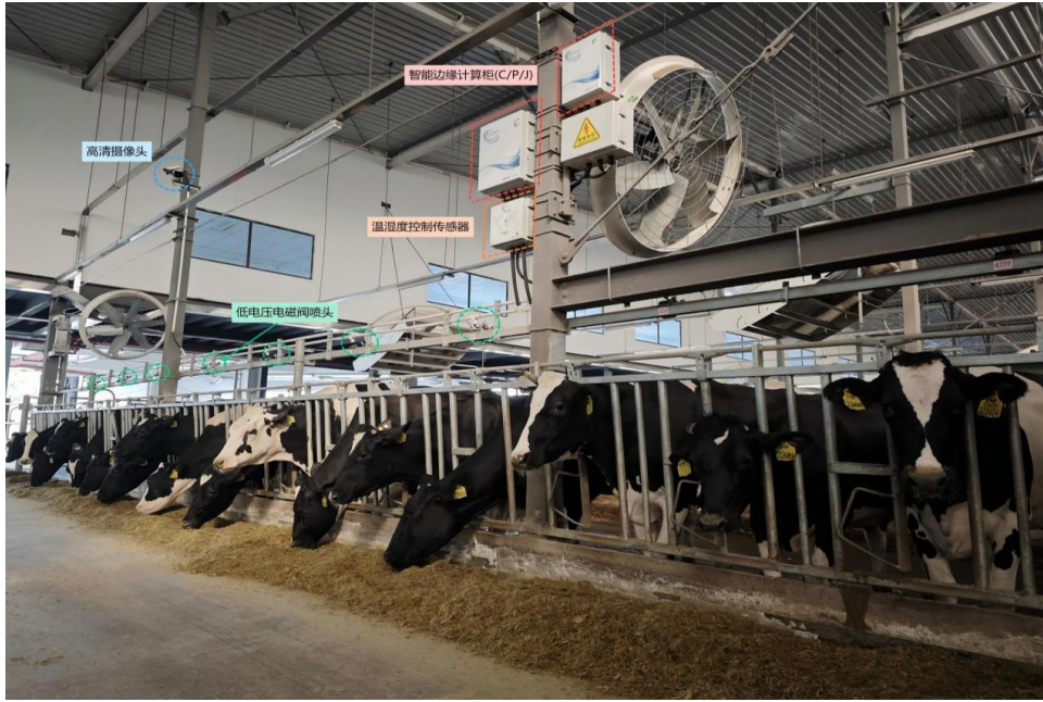
图 2 华美牧场二期智能视觉喷淋设备图
