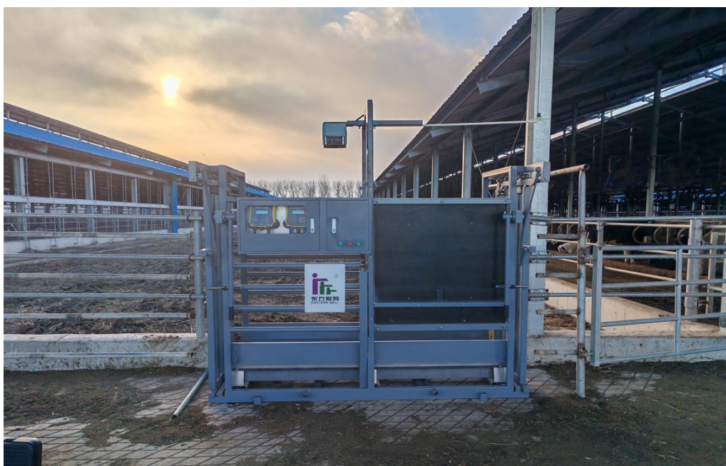
图 4 自动体重体高测量系统
